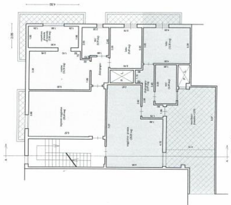
(frazionamento della unità immobiliare esistente in 2 unità) PIANTA PIANO PRIMO - STATO DI FATTO
